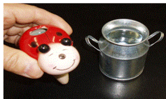
(写真1) 100 円ショップで見つけたダニエル電池の材料 (左)素焼きの 「ウォーターキーパー かわいいマスコット」 (ダイソーで購入) (右)亜鉛メッキのスチール製 「アンティークスチールミルク缶」 (セリアで購入)
